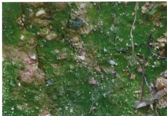
BSC-1により形成されたBSCが微粒子を付着させている例（施工2週間後）
