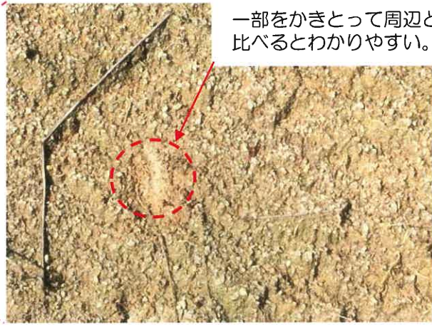
侵入植物の空地には一見何も無いように見える 一見BSCが見えなくても効果を発揮している状況の例（マサ土・45度：施工6ヶ月後）
