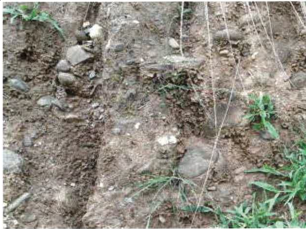
発達したBSCの上に土粒子等が付着した様子 同左 BSC自体の色も遠目ではわかりにくいBSCが形成され侵食を防止しているが見た目にわかりにくい状況の例（施工2ヶ月後）
