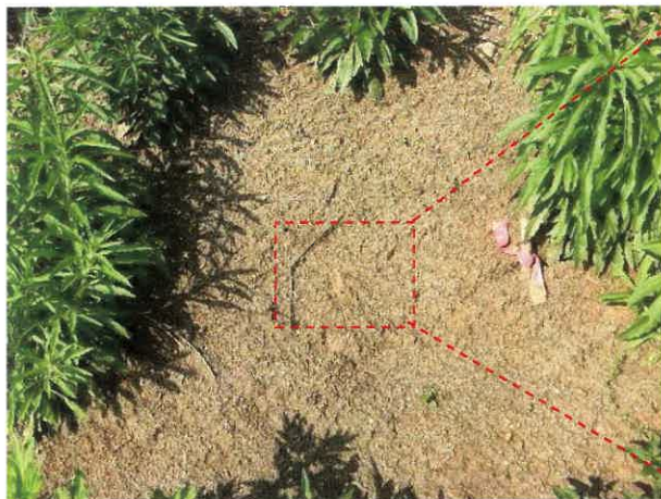
侵入植物の空地には一見何も無いように見える 一見BSCが見えなくても効果を発揮している状況の例（マサ土・45度：施工6ヶ月後）
